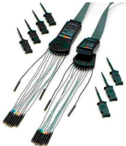
P6316MSO 探头提供两个 8 通道纵槽以简化与设备的连接。
